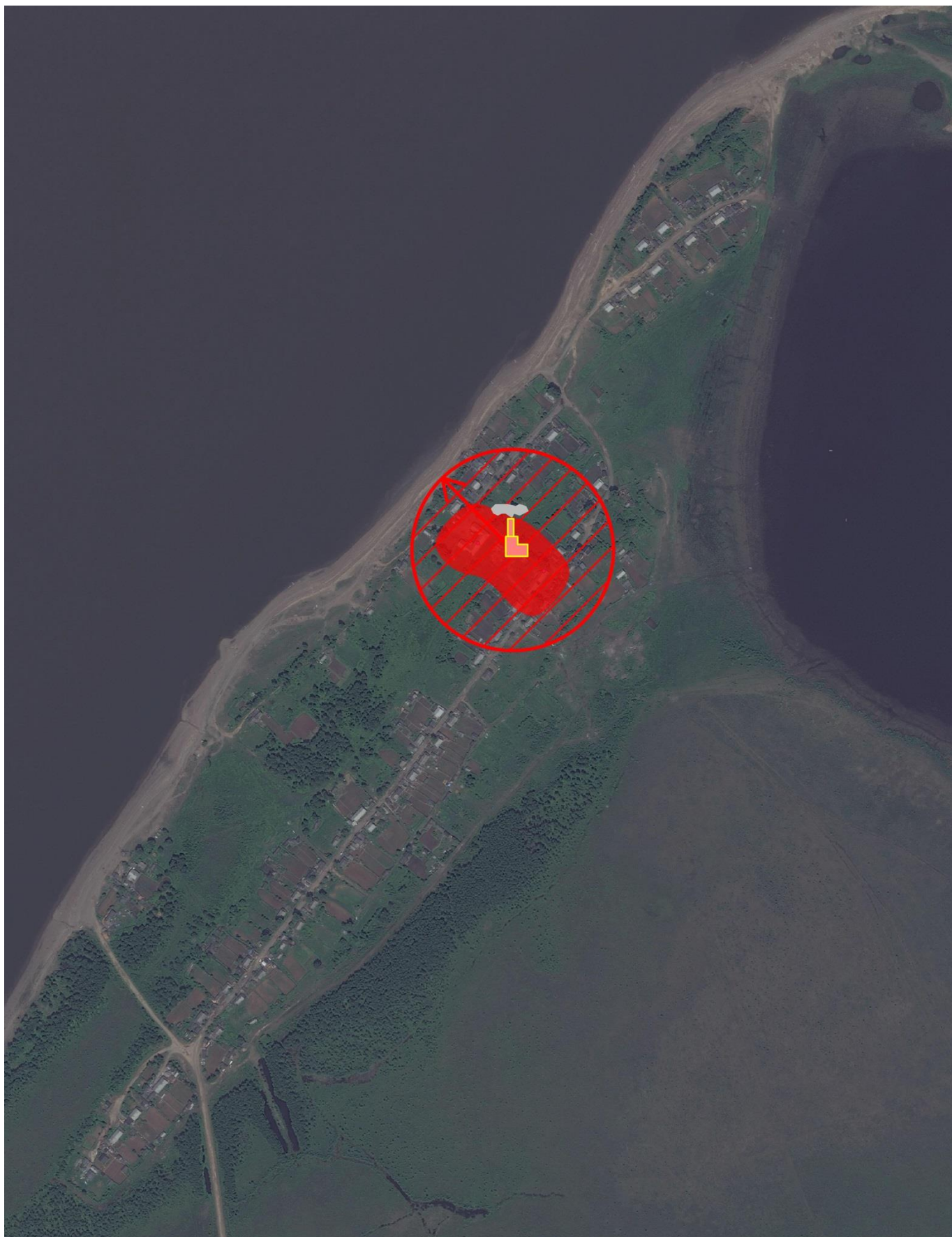
Рис. 5.3 – Радиус эффективного теплоснабжения котельной п. Быстринск
